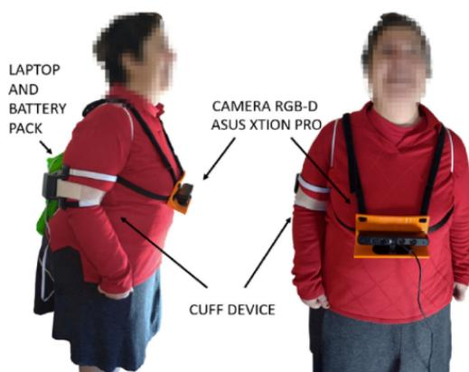
Il sistema di navigazione indossato da un *end-user*. Si possono vedere il sistema aptico indossabile (CUFF device), la camera RGB-D per acquisire informazioni sull'ambiente e gli ostacoli, e l'unità di processing per calcolare gli stimoli che il sistema aptico deve fornire all'utente per evitare gli ostacoli
